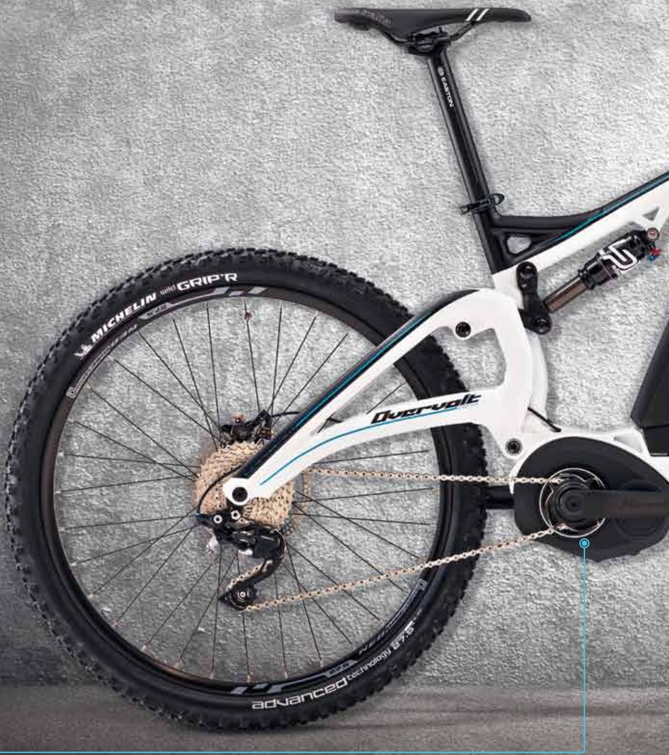
Le moteur délivre une assistance dynamique et directe sur l'ensemble de la plage de vitesse, il s'arrête automatiquement lorsque la vitesse maximum autorisée par la réglementation est atteinte. Le nouveau montage de la transmission permet une parfaite intégration du bloc moteur et augmente la garde au sol. Le bloc moteur est équipé d'une commande électronique à trois capteurs mesurant la force, la cadence de pédalage et la vitesse.
