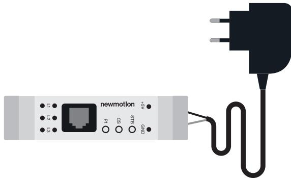
**Opmerking:** Polariteit is belangrijk! 1 van de 2 draden van de voedingsadapter heeft een gebroken witte streep. Deze draad is de GND (aardaansluiting) van de voedingsadapter en moet daarom worden aangesloten op de GND-pin (rechts) van de module. De andere draad is de +5 V-draad en moet worden aangesloten op de +5 V-pin (links) van de module. De pin in het midden wordt niet gebruikt.
