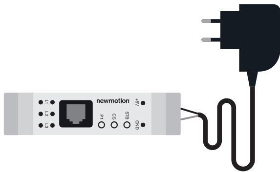
**Remarque :** La polarité est importante ! 1 des 2 fils d'adaptateur d'alimentation a une rayure blanche. Le fil rayé blanc de l'adaptateur d'alimentation doit être connecté à la borne de terre (GND) sur le module. Le fil noir deest l'adaptateur d'alimentation de terre et doit donc être connecté à la borne+5 V sur le module. Le bornier du milieu n'est pas utilisée.
