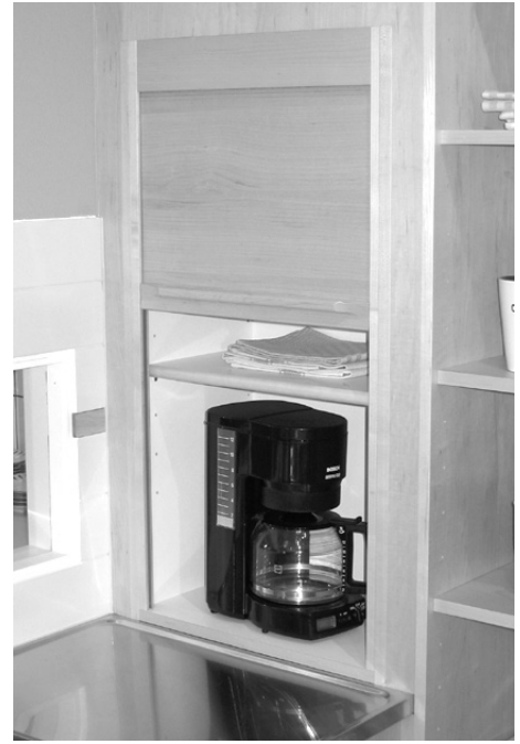
Rulo-ovella varustettu yksikkö, jonka ovi on osittain auki. Kiinnitä kokoonpanossa huomiota siihen, etteivät sivut joudu puristuksiin, koska se voi jumiuttaa rulo-oven.
