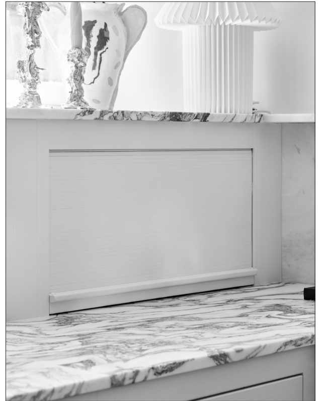
Rullaoviyksikkö ovi suljettuna. Varmista asennuksen aikana, että yksikön sivut eivät ole joutuneet puristuksiin, koska se voi tehdä rullaovesta jäykän käyttä.
