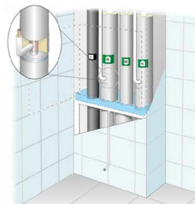
4.1.2b Prefabricerad konstruktion, schaktbotten.
