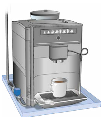
4.2.1a Vattenansluten utrustning.
