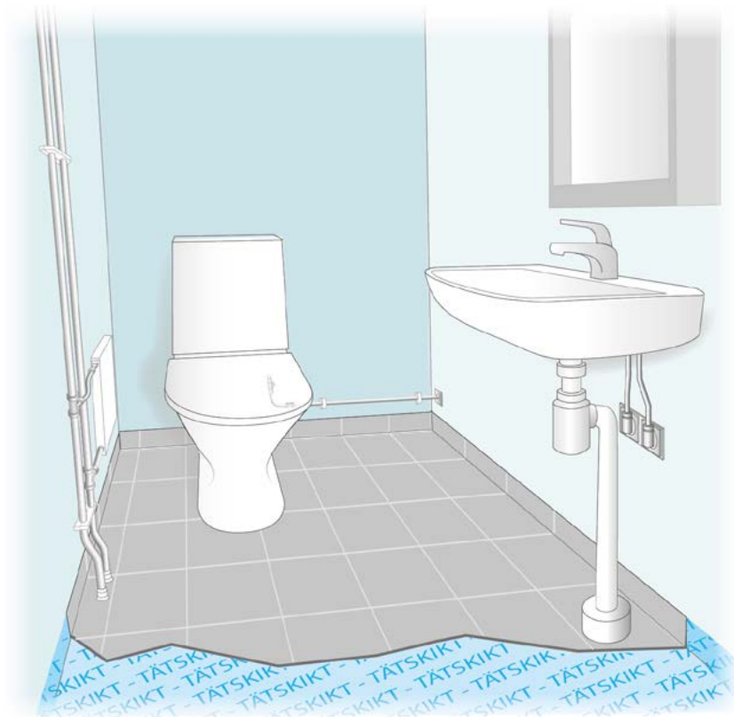
4.6.2a Rör genomföring i golv i WC-rum.
