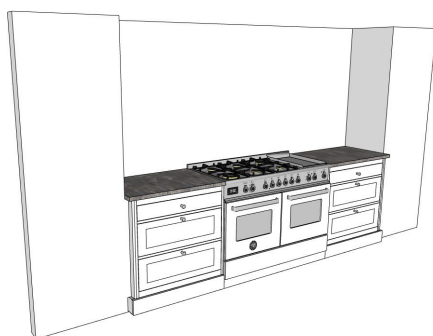
Montera underskåp i väggnisch. /Install base unit in wall niche.
