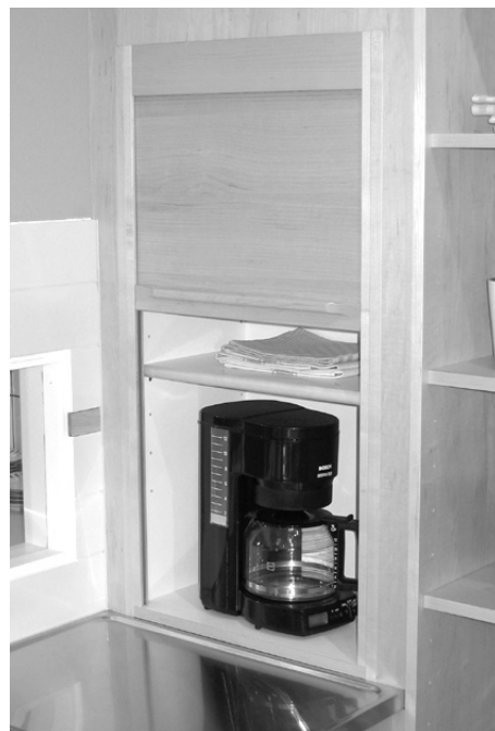
Rullaovella varustettu yksikkö, jonka ovi on osittain auki. Kiinnitä kokoonpanossa huomiota siihen, etteivät sivut joudu puristuksiin, koska se voi jumiuttaa rullaoven.
