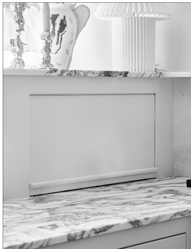
Jalusiskåp med stängd lucka. Var noga vid monteringen så att sidorna på skåpet ej pressas samman. Jalusiluckan kan då bli trög att manövrera.
