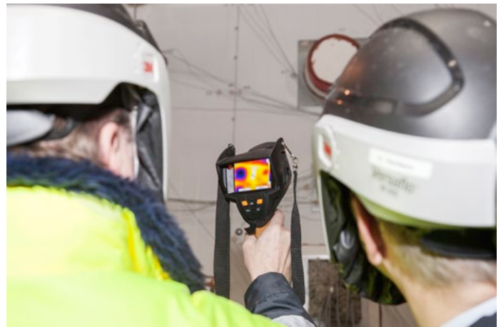
Contrôle des essais au feu par thermographie
