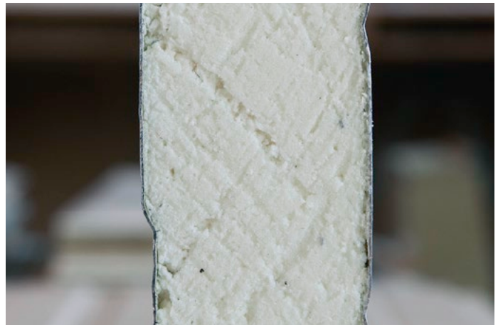
Coupe transversale d'un panneau isolant PU (classe d'inflammabilité B). Ce matériel a de meilleures propriétés isolantes et est ignifuge.
