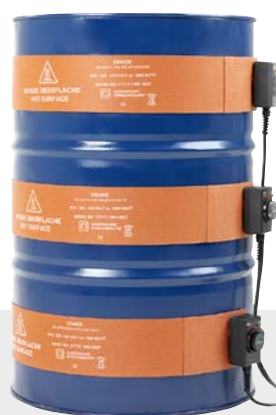
Verwarmingsband HG-F, flexibele verwarmingsband van silicone. Temperatuurregeling tot 150 °C.
