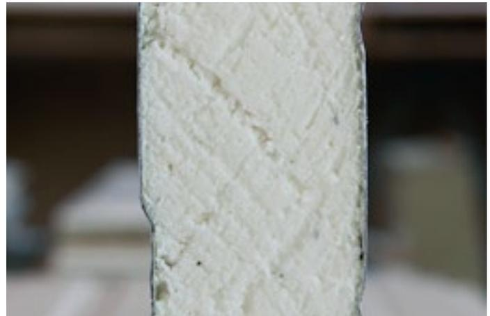
**Schnitt durch die Wandisolierung aus PUR-Paneelen (Baustoffklasse B). Dieses Material hat bessere Dämmeigenschaften und ist schwer entflammbar.**
