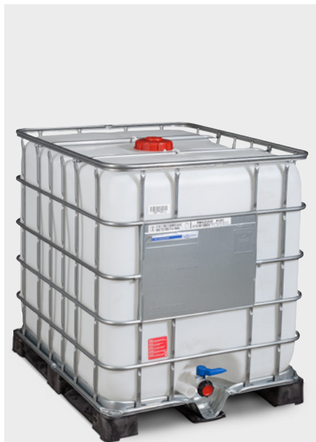
Kontener IBC do mat. niebezpiecznych, paleta z PE, 1000 l, otwór DN 150, wylot DN 50, z dopuszczeniem UN, nr art. 266-167-M1
