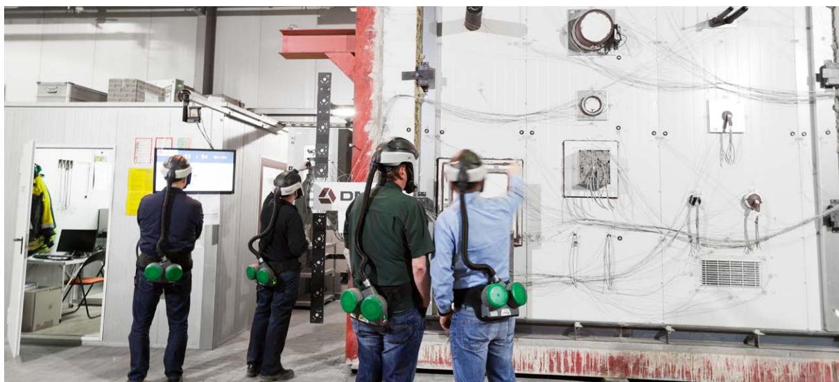
Réalisation réussie d'un essai au feu pour différents types de joints d'étanchéité au feu (pénétrations de câbles et de tuyaux).
