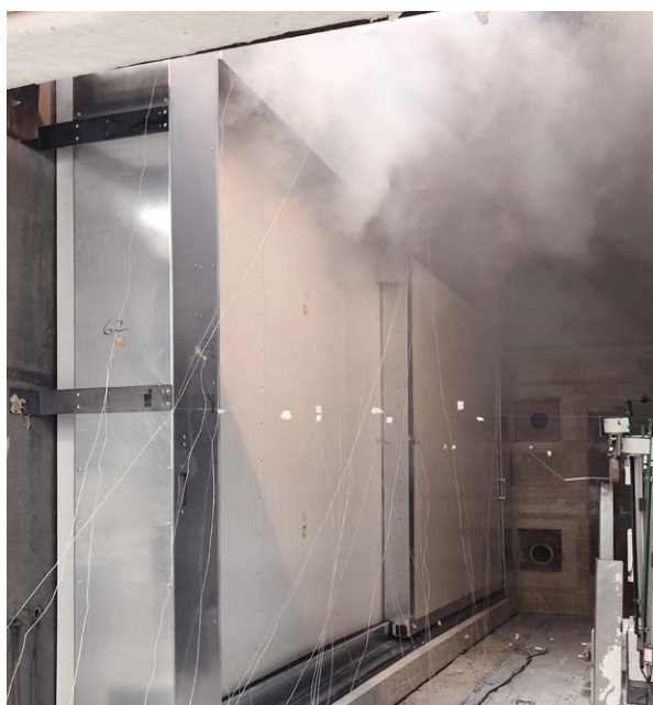
RFP SD avec portes coulissantes en essai au feu. De la fumée sort des joints, mais il n'y a pas de pénétration de flamme. L'instant d'après, le mécanisme de protection va agir et supprimer la fumée.
