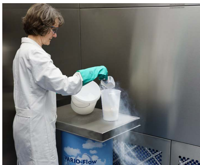
Afb. 6: Afzuiginstallaties kunnen werknemers effectief beschermen zonder hen fysiek te beperken.
