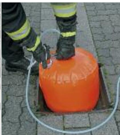
*El sellado, resistente a las sustancias químicas y de fácil limpieza, se adecua perfectamente a la geometría irregular de canales y alcantarillas.*
