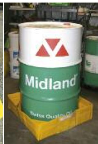
*Cubeto antiderrames móvil reutilizable para reaccionar rápidamente en caso de fuga en un bidón.*
