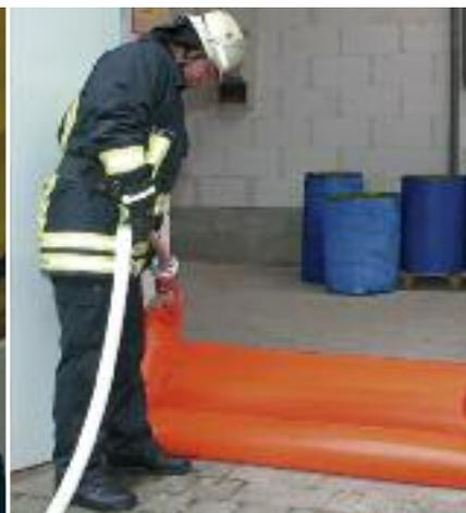
*Barreras de sellado de rápida intervención para contención de aguas de extinción e inundaciones.*
