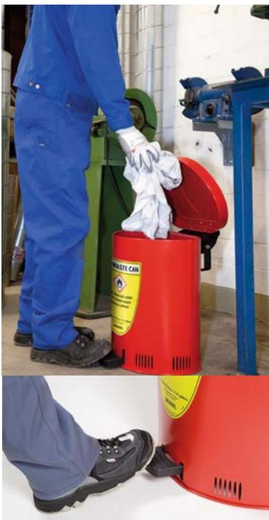
Sicheres Öffnen durch großflächiges Pedal mit rutschhemmender Oberfläche
