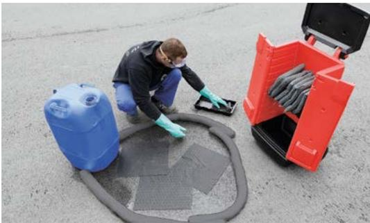
Die herausnehmbaren Auffangschalen des Transportwagens sind ideal zum Auffangen von herabtropfenden Flüssigkeiten bzw. zur vorübergehenden Sammlung der flüssigkeitsgetränkten Aufsaugtücher.
