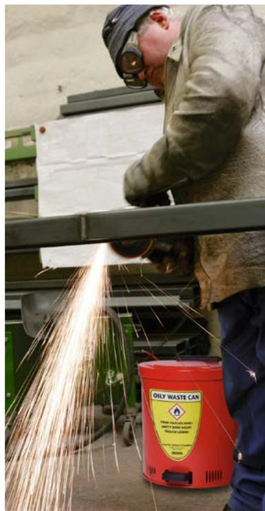
Der selbstschließende Deckel verhindert ein Entzünden des Inhalts, z. B. durch Funkenflug.
