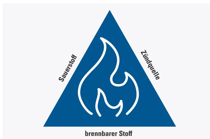
Damit es zu einer Explosion kommt, sind immer drei Komponenten erforderlich: Ein brennbarer Stoff, Sauerstoff in der erforderlichen Konzentration und eine Zündquelle. Elektrostatische Entladungen können hier unter entsprechenden Umständen zur Zündung führen.
