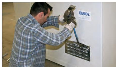
**EN 1628** Prüfverfahren für die Ermittlung der Widerstandsfähigkeit unter statischer Belastung. Durch das Aufbringen statischer Lasten werden Druckkräfte erzeugt und somit Grundfestigkeiten geprüft.
