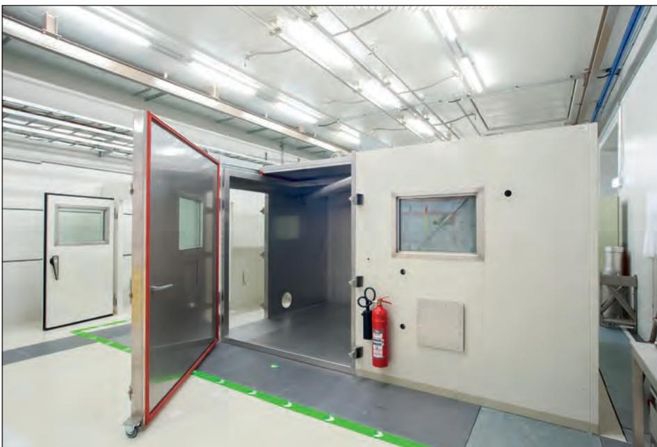
Komfortable Einbringsituation auch für sperrige Teile durch ein großes Tor in der Front sowie eine Schleuse im Dachbereich
