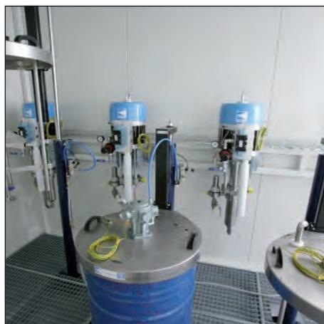
2 Befestigung der Einbauten im Lack-Mischraum
