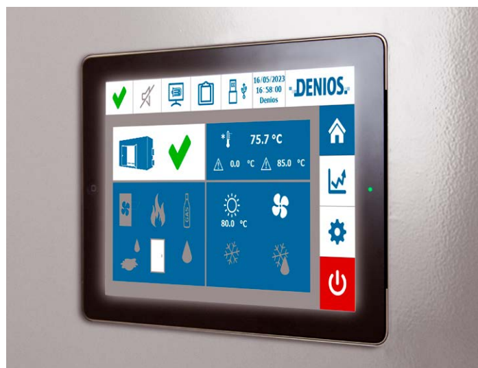
Afb. 4: Gebruikersscherm van het touchdisplay van de PLC
