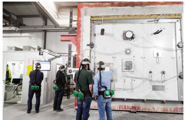
Brandprüfung von Einbauten und verschiedenen Komponenten
