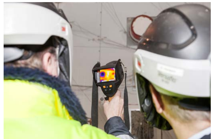
Überprüfung der Brandversuche mittels Thermographie
