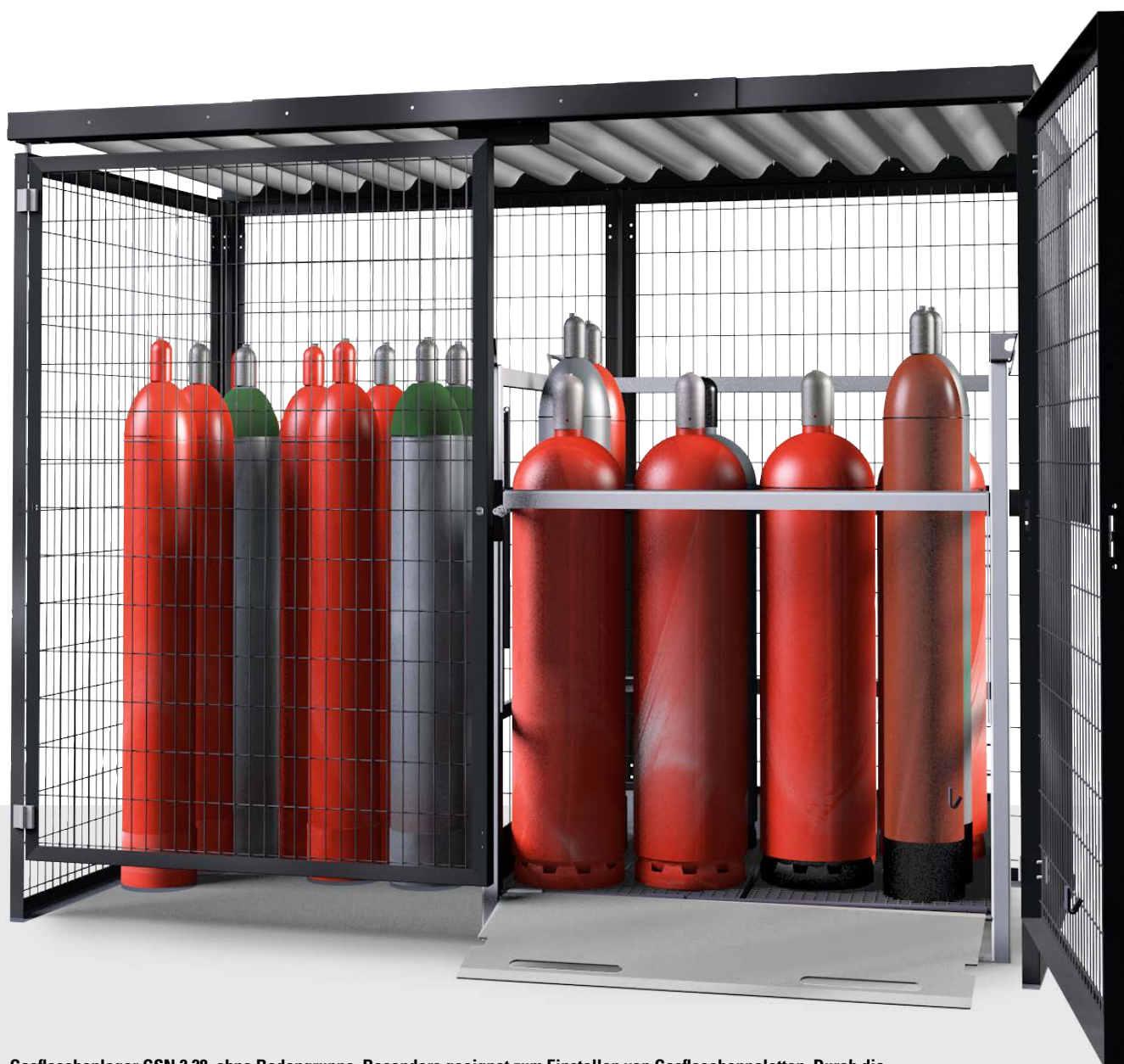
Gasflaschenlager GSN 2.28, ohne Bodengruppe. Besonders geeignet zum Einstellen von Gasflaschenpaletten. Durch die Bodenfreiheit der Tür von 160 mm lässt sich das Gasflaschenlager auch bei geöffneten Gasflaschenpaletten wieder verschließen.
