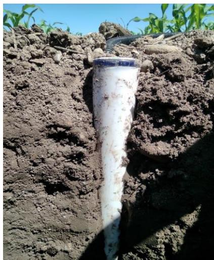
*Sensore per la rilevazione di temperatura e umidità del suolo.*
