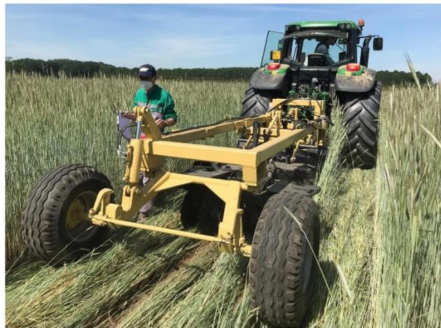
*Terminazione della segale allo stadio di antesi avvenuta il 19/05/2021 con un passaggio del prototipo (rullo crimper + doppia dischiera, trattamento 2). Nell'immagine sotto a sinistra si nota il passaggio dello strip till a seguito del passaggio di rullo crimper (trattamento 4). Nell'immagine sotto a destra si nota la crescita di soia e di infestanti nel trattamento 2 (foto scattata il 25/7/2021).*
