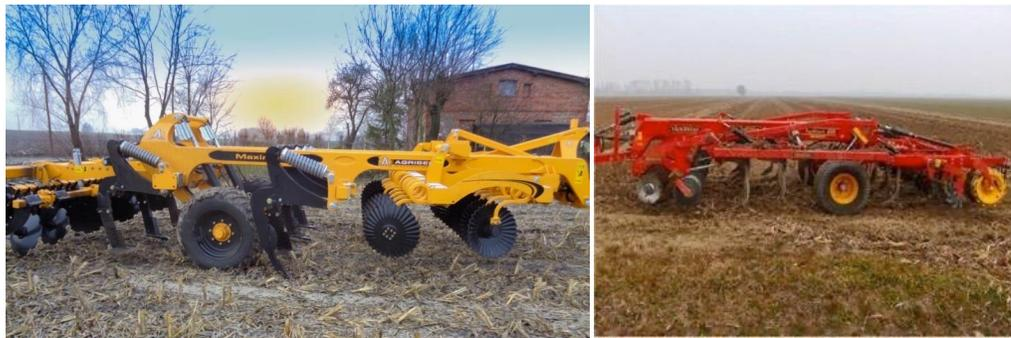
La qualità del lavoro, intesa come miscelazione del residuo, rottura dello strato superficiale e livellamento, migliora operando a velocità molto sostenuta.
