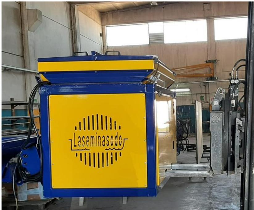
Figura 1. Fotografia del prototipo della macchina seminatrice che verrà utilizzato per seminare le cover crop in abbinamento a rincalzatrice, trinciastocchi, botte del liquame e mietitrebbia.
