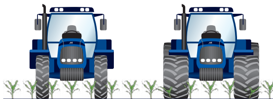
Трактор оснащен узкими шинами «Mitas»
