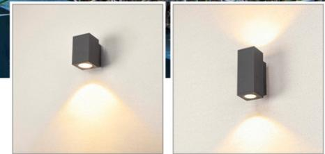
Gamme complète d'appliques et de plafonniers extérieurs en LED intégrée, déclinés en trois tailles pour chaque version. Appliques avec faisceau vers le bas ou up/down. Facilité de montage : une seule vis de fixation, bornier de connexion rapide, assemblage de la patère au luminaire par simple fiche, double presse-étoupe rapproché pour une seule sortie de câble.
