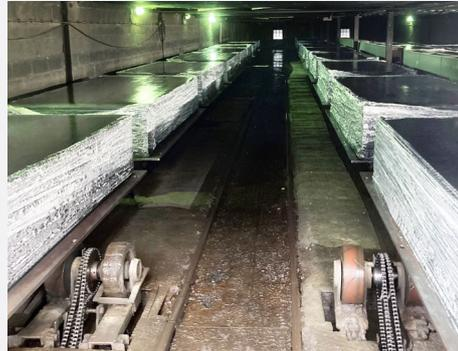
Die Puro-Plus-Platten sind luftgetrocknet und **härten unter normalen Luftbedingungen mindestens vier Wochen lang aus**. Unmittelbar nach dem Pressen werden die Platten zunächst mehrere Stunden lang in einem Trockenraum bei einer Temperatur von 50 °C getrocknet. Danach trocknen sie an einem normalen Lagerort weiter bis ein Feuchtigkeitsgehalt von etwa 12 % erreicht ist. Anschließend werden
