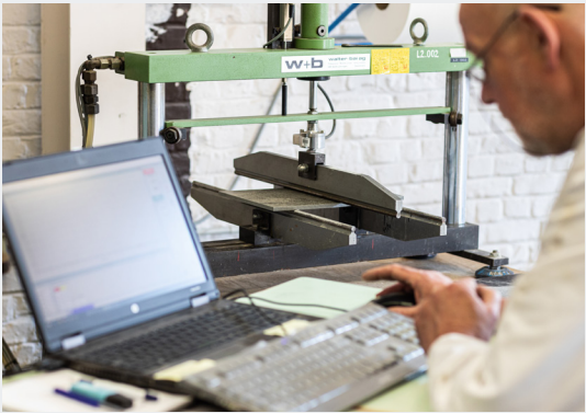
Labotesten bevestigen de uitzonderlijke sterkte van de Puro Plus platen.
