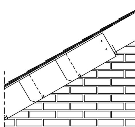
Der freie Überstand über die fertige Konstruktion beträgt 40 bis 60 mm.
