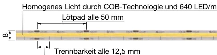
Lineares LED-Band mit Chip on Board COB Technik.
