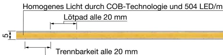
Lineares LED-Band mit Chip on Board COB Technik.
