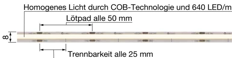
Lineares LED-Band mit Chip on Board COB und **DualColor** Technik.
