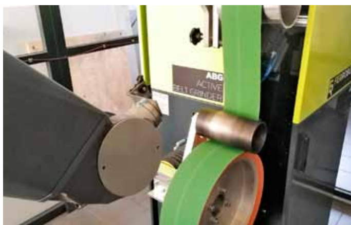
Testy na pásové brusce od Ferrobotics
