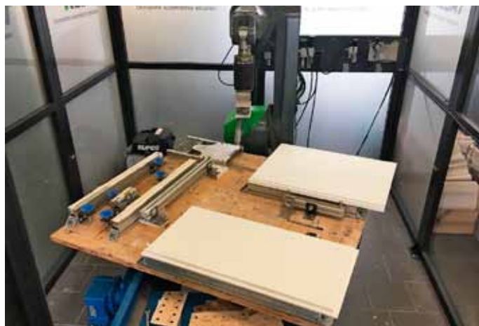
Leštění polyuretanového laku pro nábytkářský průmysl
