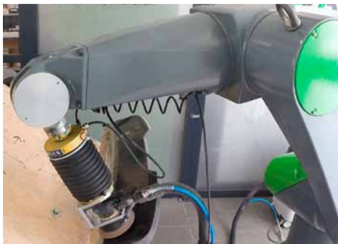
Zkouška odstranění mastnoty z výlisku
