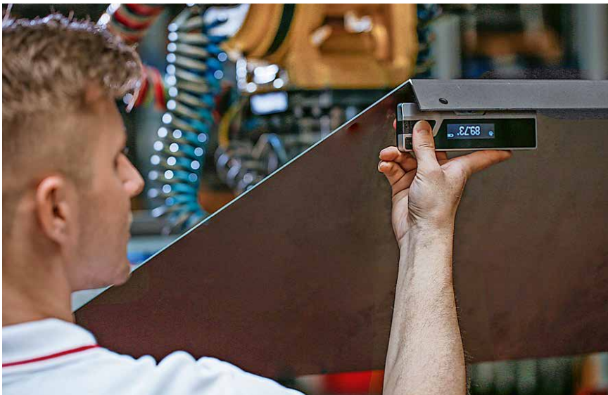
Durch die einfache und schnelle Montage per Magnete am Oberwerkzeug ist der Winkelmesser an jeder Abkantpresse einsetzbar
