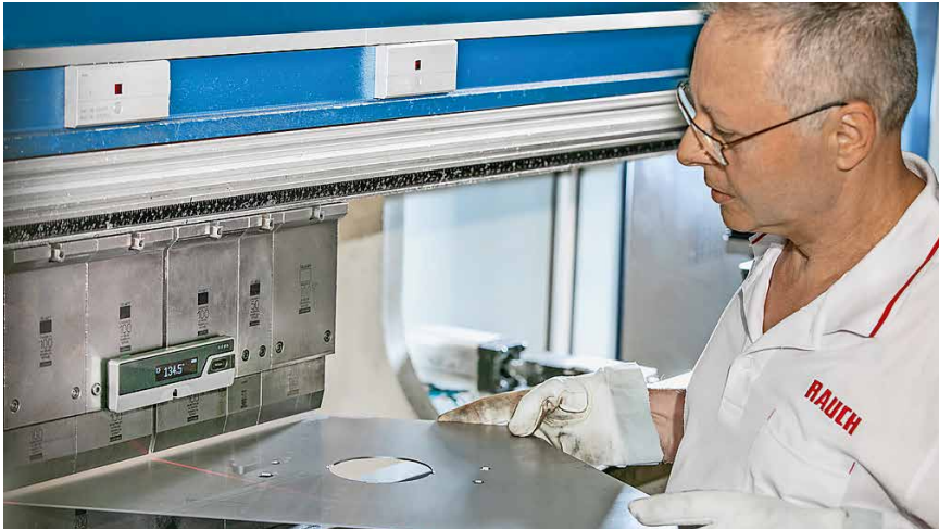
Durch die einfache und schnelle Montage per Magnete am Oberwerkzeug ist der Winkelmesser an jeder Abkantpresse einsetzbar
