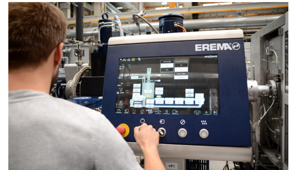
KeTop AP521 Multitouch mit EREMA Visualisierung | ©KEBA 2023
