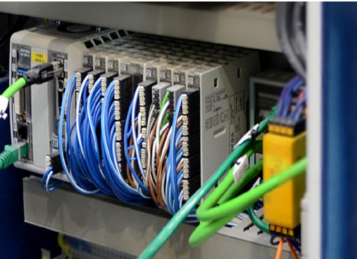
KeControl C5 Steuerung & KeConnect E/A-Module | ©KEBA 2023
