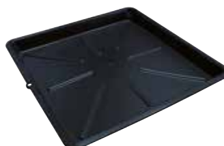
#4821901 Bac récupérateur de fluides 20L - Compartimenté - Matière plastique - Capacité 20L - Bac verseur intégré - Dimensions 685 x 667 x 65mm
