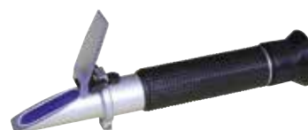
#822002 Handrefraktometer - Zur Prüfung von Batteriesäuredichte von 1,1 - 1,4kg/l - Frostschutzgehalt im Kühlwasser von 0° / -50°C - Scheibenwischwasser von 0° / -40°C - Justierbares Okular
