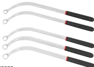
#812002 Spannrollenschlüssel-Satz 5-tlg. - Zum Entspannen der automatischen Spannvorrichtung - Problemloses Wechseln des Zahnriemens - Erspart bei VAG die Servicestellung der Kühleinheit - Für schwer zugängliche Stellen - Mit kunststoffbeschichtetem Griff - Chrom-Vanadium - 13 - 15 - 16 - 17 - 19 mm - 470mm
