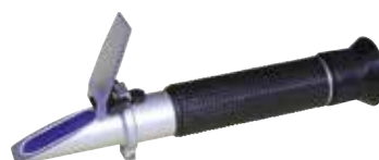
#822002 Refractometer - Controleert soortelijk gewicht van accuzuur (1,1 - 1,4 kg/l) - Meet antivriesgehalte in koelwater (0° tot -50°C) en ruitenwisservloeistof (0° tot -40°C) - Afstelbaar oculair en instelbare ijkvoorziening - Meetnauwkeurigheid ±5% - VAG OEM: T10007 A
