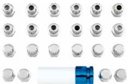
#829006 Wielmoersleutel set - geschikt voor Audi, 22-dlg. Compleet met 21mm adapter met 1/2" aansluiting vierkant. Deze set is bedoeld voor het verwijderen van slotbouten als de klant is vergeten de originele dop bij de auto te leveren. Komt overeen met OEM T40073.
