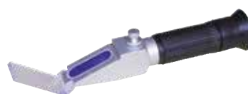
#822001 Adblue refractometer - Controle van soortelijk gewicht van accuzuur (1,1 - 1,4 kg/l) - Meting van antivries in koelwater (0° tot -50°C) en ruitenwisservloeistof (0° tot -40°C) - Afstelbaar oculair, instelbare ijkvoorziening - Meetnauwkeurigheid ±5% - VAG OEM: T10007 A
