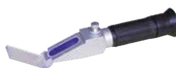
#822001 Adblue refractometer - Geschikt voor het testen van de correcte mengverhouding bij AdBlue®-toevoegingen - Ter controle van soortelijk gewicht van accu zuur van 1,1 - 1,4 kg/l en antivriesgehalte in het koelwater van 0°/-50°C evenals ruitenwisservloeistof van 0°/-40°C
