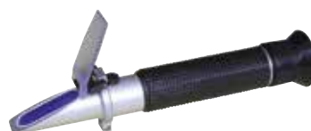
#822002 Refractometer - Ter controle van soortelijk gewicht van accu zuur van 1,1 - 1,4 kg/l en antivriesgehalte in het koelwater van 0°/-50°C evenals ruitenwisservloeistof van 0°/-40°C - Afstelbaar occulair, - instelbare ijkvoorziening - Meetnauwkeurigheid +/- 5%, - VAG OEM T10007 A
