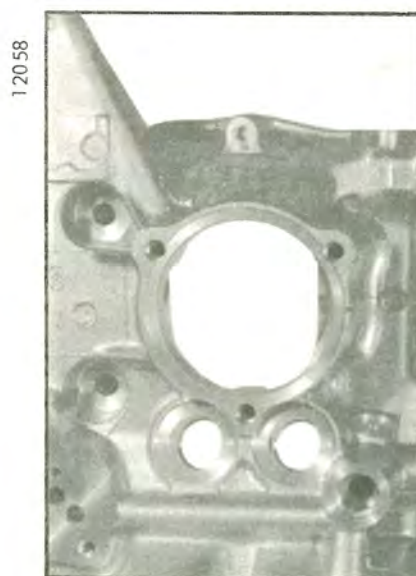
Abb. 2 Gehäuse neuer Bauart mit erhöhtem Auflegewulst
