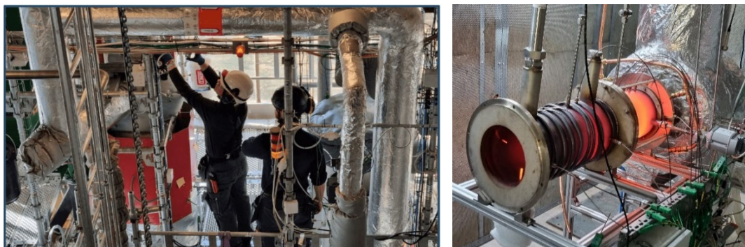
Figur 18: Förgasningssystem (vänster) och brännkammare (höger) i den integrerade testriggen, Scarlett, i Stockholm.
