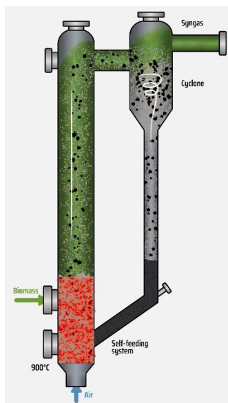
Figur 7: Skiss över HFB förgasaren. För produktion av industrigas används syre i stället för luft, då man vill minimera mängden kvävgas i processen.
