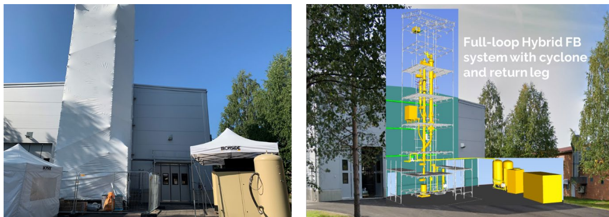
Figur 14: Humphreys testrigg i Piteå i 5 MW skala med syfte att optimera och validera funktion av en Hybrid fluidiserad bädd.
