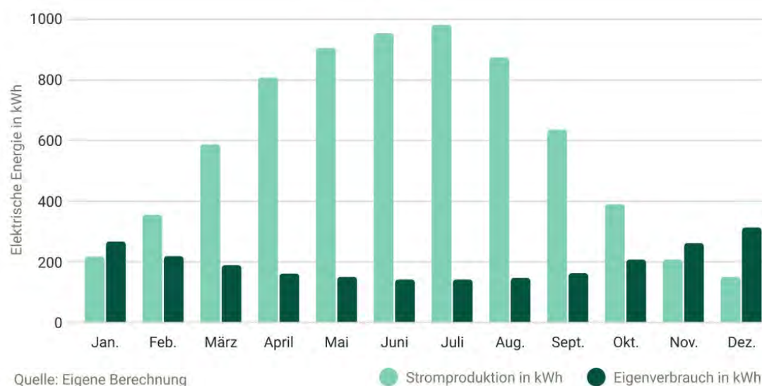
Abbildung 52: Beispielhafte Grafik einer Stromproduktion und Eigenverbrauch eines Einfamilienhauses mit einer 7.000kWp PV-Anlage und einem eigenen Stromverbrauch von 2.500kWh 75
