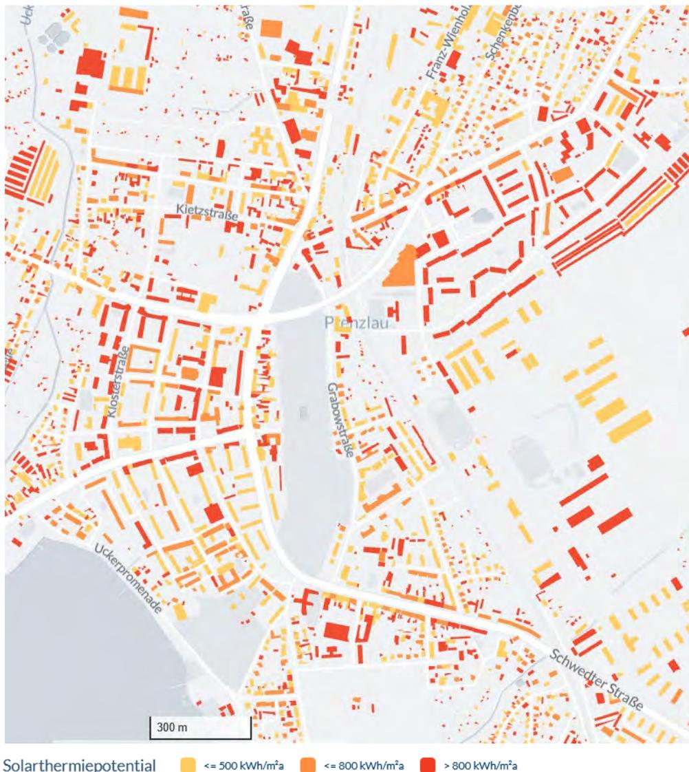
Abbildung 41: Farbige Darstellung des Wärmepotenzials der Solarthermie in Prenzlau (Ausschnitt) – vgl. Digitalen Zwilling zwecks weiteren Detailinformationen<sup>53</sup>
