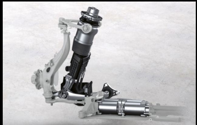
Eine elektrisch betriebene Hydraulikpumpe baut aktiv Kraft im Stossdämpfer auf.
