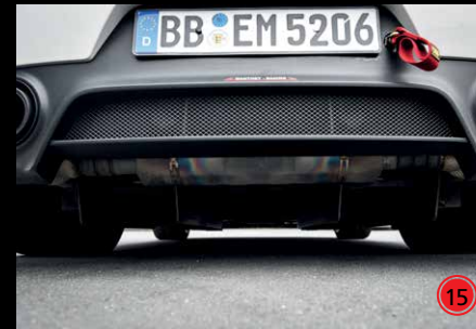
MR DIFFUSOR* Abtriebsoptimierter hinterer Unter- boden
