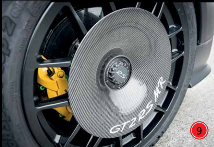
MR CARBON AERODISC* Leichtbau Radabdeckung zur Abtriebs- optimierung
