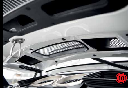
MR CARBON MOTORDECKEL* Motordeckel in Leichtbauweise
