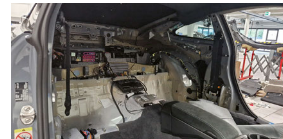
Zerlegter Fahrzeuginnenraum – montierte Carbonplatte ersetzt die Heckscheibe für einen noch tieferen Schwerpunkt
