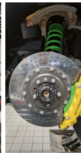
Links: diverse Teile aus dem Kit Rechts: semi-aktives Gewindefahrwerk mit Hochleistungsbremsbelag
