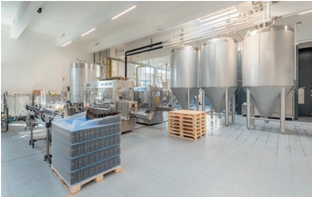
Les deux installations de remplissage pour les canettes et les bouteilles (au premier plan) ainsi que les cuves de fermentation et la salle de brassage de la Brasserie Thun AG à l'arrière-plan.
