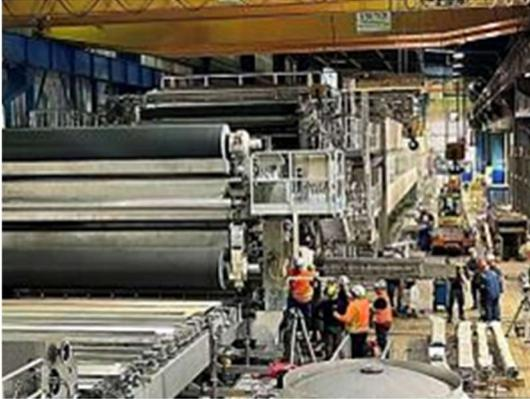
Der gesamte Rahmen im Bereich der Siebpartie in der Zellstoffmaschine 3 (ZEM 3) wurde grunderneuert, alle Maschinen wurden gewartet, geprüft und wieder in Schwung gebracht.
