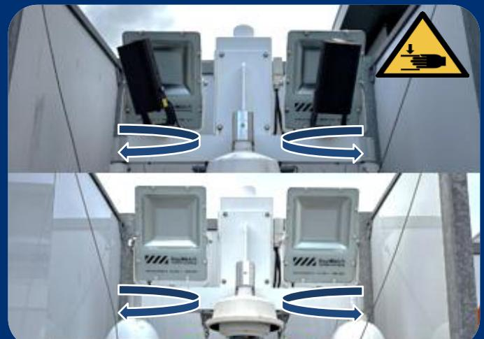
3. Gire las luces en la dirección de los ángulos de visión que se van a supervisar. Si hay luces infrarrojas, gire solo estas.
