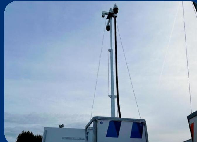
7. Extienda el mástil completamente hasta que los cables de sujeción estén tensos.
