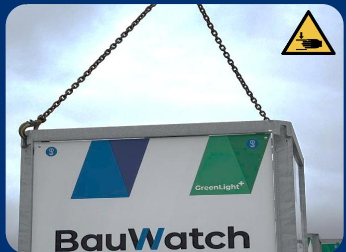
3. Utilice una cadena de elevación homologada (mínimo 2 ramales) en forma de cruz paraizar la torre. Utilice las argollas de elevación.
