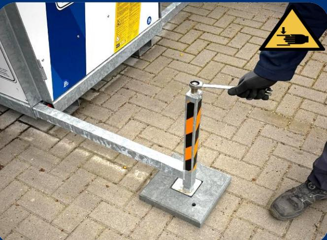
2. Tire de las patas de apoyo y coloque una baldosa debajo. Utilice la llave inglesa de 19 mm para desenroscar las patas. Utilícela para nivelar la torre.
