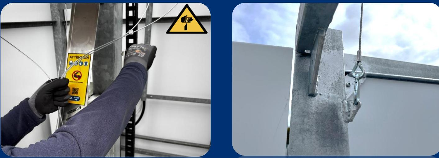
6. Bevor der Mast vollständig ausgefahren ist, überprüfen Sie die Haken erneut, um sicherzustellen, dass sie noch fest sitzen.
