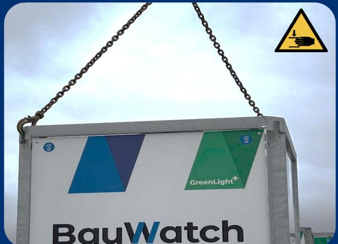
3. Verwenden Sie eine zugelassene Hebekette (mindestens 2-strängig) quer, um den Turm anzuheben. Verwenden Sie die Hebeösen.
