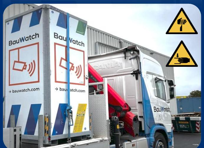
5. Fissare la torre utilizzando una cinghia di fissaggio, avendo cura di garantire che il telaio non si pieghi.
