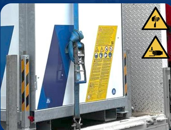
6. Fissare la lunghezza in eccesso della cinghia di fissaggio.
