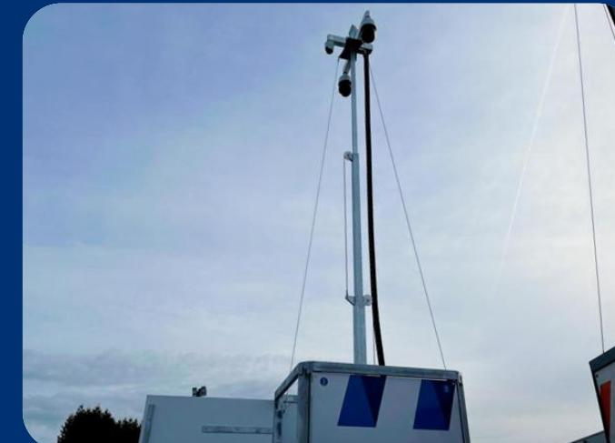
7. Estendere completamente il palo fino a quando i tiranti sono tesi. **Attenzione:** non ruotarlo con forza eccessiva!
