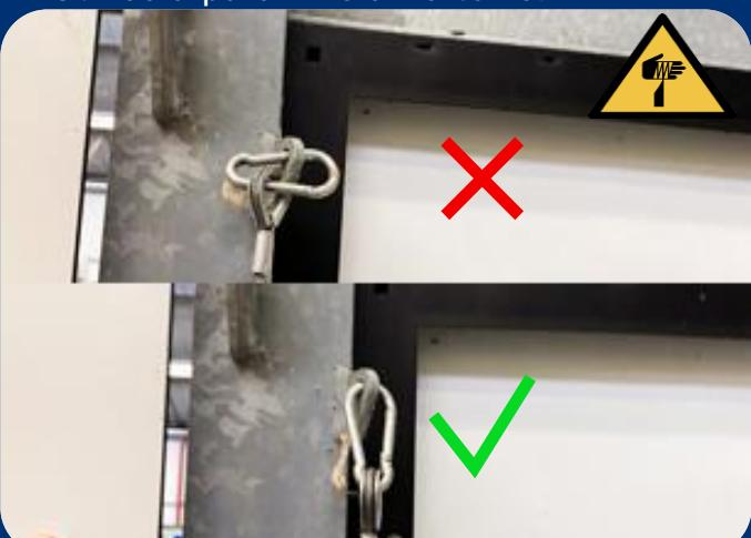
5. Antes de levantar el mástil, compruebe que los ganchos de los cables de sujeción se pueden mover libremente en el orificio.
