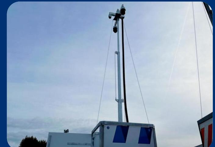
8. Extienda el mástil completamente hasta que los cables de sujeción estén tensos. **Nota:** ¡no lo gire con fuerza excesiva!
